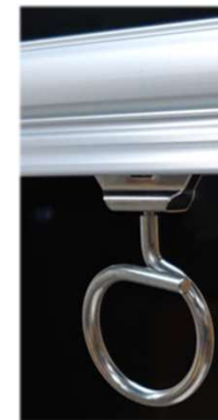
IVフック H-9型 材質 本体SUS304 フック部 Φ45 許容荷重 15kg
